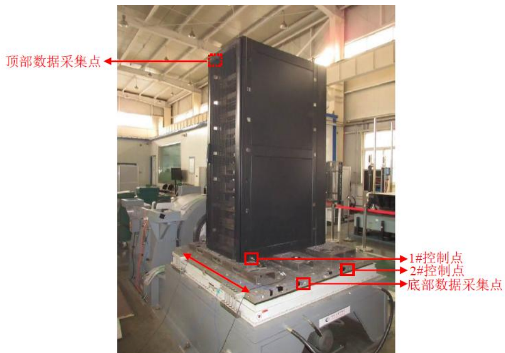
图 5：机柜动态测试现场照片
